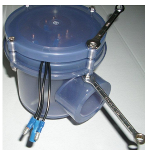
Figura 3 - Retirar os parafusos.
