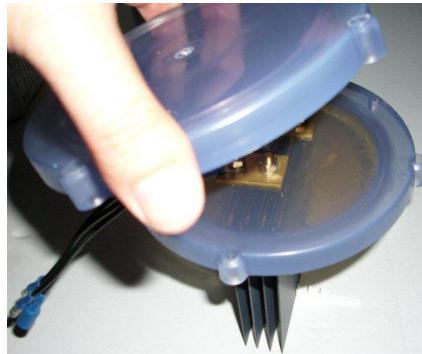
Figura 7 - Retirar a tampa superior de PVC.
