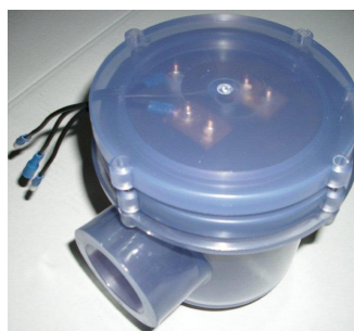
Figura 10 - Colocação da tampa de PVC.
