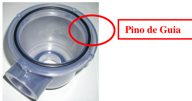
Figura 8 - Colocação do novo o-ring.
