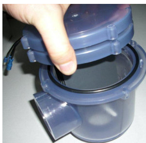
Figura 5 - Retirar o kit de eléctrodos do vaso.
